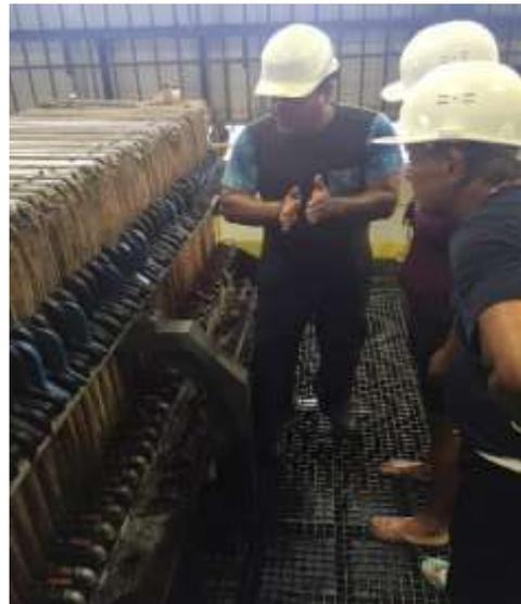
4<sup>ème</sup> étape : Le coprah broyé est ensuite acheminé par une tuyauterie chauffée à partir des vapeurs régénéré par une chaudière. Puis, il sera pressé durant 24h00 pour obtenir l'huile.
